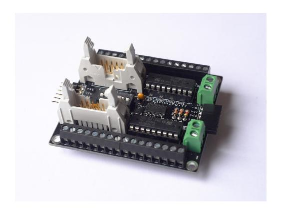
Avant de le mettre sous tension, vérifiez bien une dernière fois la position des composants et la qualité des soudures. Faites surtout bien attention à respecter la polarité des connecteurs d'alimentation, masse vers le bas.
