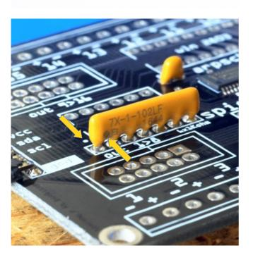
Le petit condensateur (104) n'est pas polarisé. Par contre le réseau de résistances l'est: placez le petit point du composant en face de celui de la sérigraphie, comme indiqué par les flèches sur la photo.
